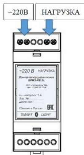
Рисунок 2: Схема подключения «БРИЗ-РВ.SL»
