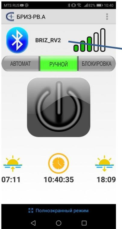
АВТОМАТ – основной режим, при котором контроллер работает без вмешательства, используя расчет астрономического времени восхода и захода солнца.
