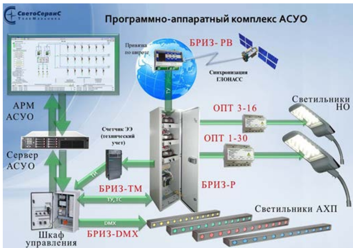
Рисунок 1 - Схема организации управления АСУО «БРИЗ»
