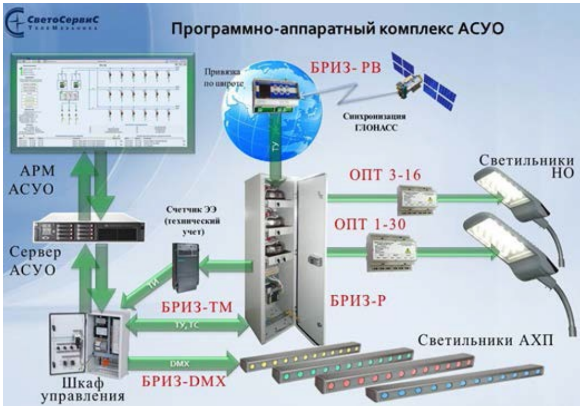
Рисунок 1 - Схема организации управления АСУ «БРИЗ»
