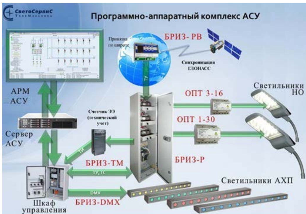
Рисунок 1 - Схема организации управления АСУ «БРИЗ»
